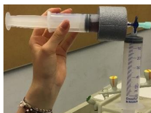
Abb. 2: Experimentiersetting zur Untersuchung der Temperaturabhängigkeit der Löslichkeit von CO 2
