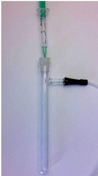
Gasentwickler 1: Reagenzglas mit seitlichem Ansatz; durchbohrter Stopfen
