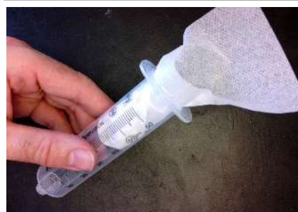
Gasentwickler 2: Teebeutel in einer Spritze
